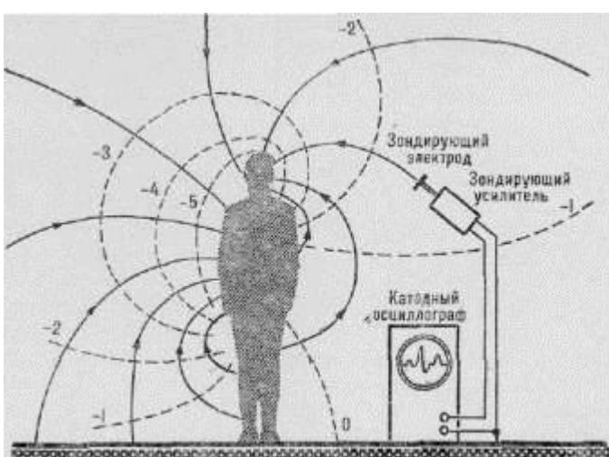
Рис. 28. Схема установки для ауэральной системы регистрации электрических полей,
